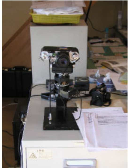
図4.ニコン F2 にベローズを付けレンズを逆向きに装着しマクロリングライトをつける.地衣類の部分拡大撮影に威力を発揮する.
