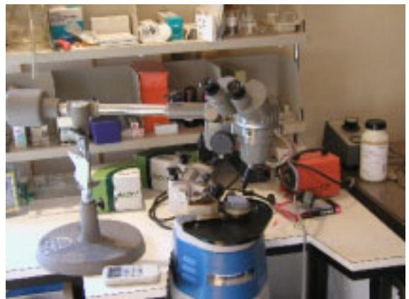
図2. 凍結マイクロトーム 実体顕微鏡との組み合わせ。簡易の脱気装置も見える。
